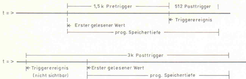
Bild 3. Bestimmung des Triggerereignisses. Oben: Speichertiefe = 2 KSample, Posttrigger = 512 Sample.
